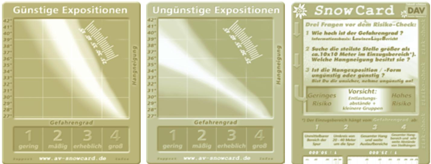
Die Grafiken der SnowCard mit der günstigen und der ungünstigen Grafik. Die verschiedenen Grafiken werden durch senkrechtes Kippen der Plastikkarte im Hologramm sichtbar. Rechts die Rückseite der SnowCard mit der Anleitung zum Gebrauch inkl. dem Beurteilungsradius der Hangneigungsbestimmung.
